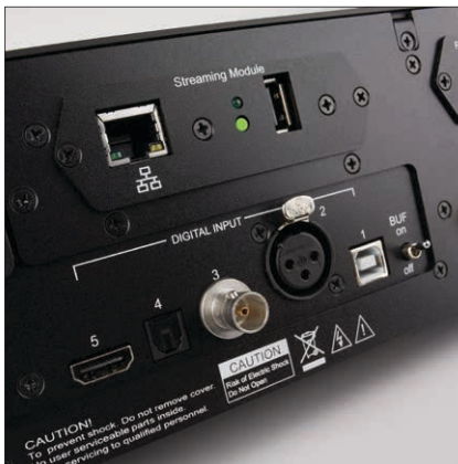
Der kleine Schalter dient dem Zuschalten der Buffer-Funktion für die digitalen Eingänge
